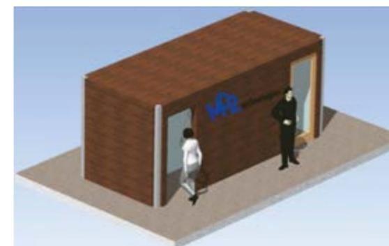
Sacop. Modélisation du sas représentant la face avant, avec la porte d'entrée des personnes à vérifier et la porte d'accès de l'employé de sécurité. Modélisation réalisée par le pôle mécanique de MC2 Technologies
