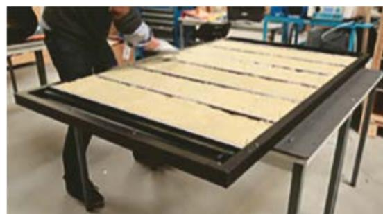
Fabrication du module DualSun étape de pose des isolants
