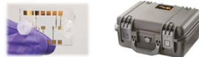
A gauche : puce microfluidique intégrant des microcapteurs électrochimiques.
