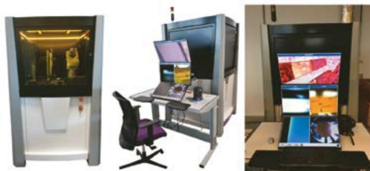
Machine robotisée avec des interfaces de l'industrie 4.0, ici pour l'assemblage et la soudure laser d'applications sur cadran de montre
